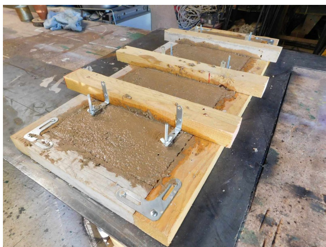
Coffrage de la porte du four - E
