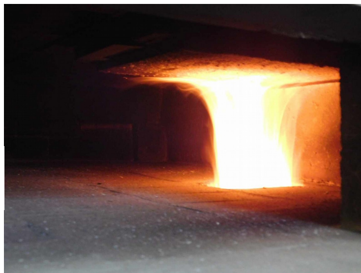
Sortie du gueulard : flamme de chauffe - E
